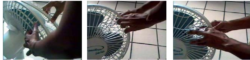
Figuras 5,6 e 7 - Simulação do acidente com o ventilador. Fonte (Correia, 2002)
