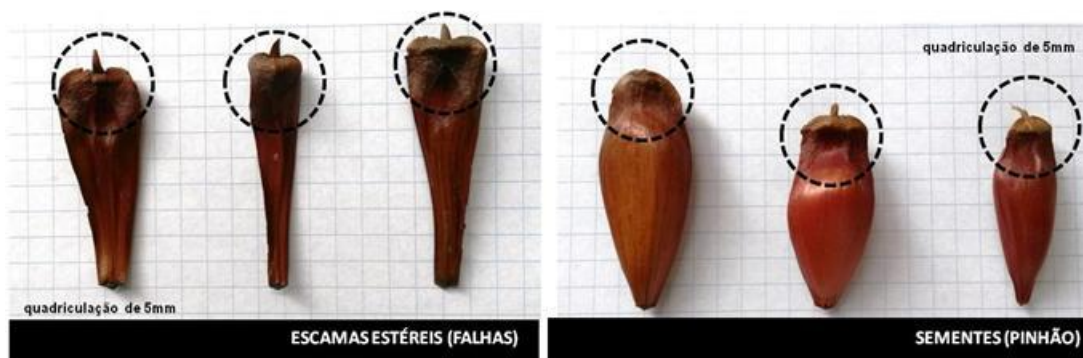
Figura 6: Elementos que compõe as escamas estéreis não moídos e que tornam o material heterogêneo. [Fonte: Os autores]
