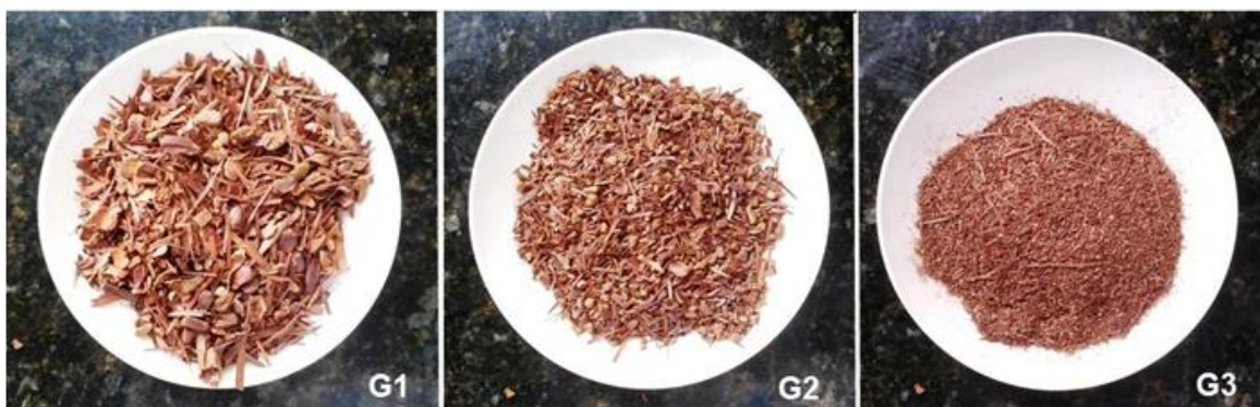
Figura 5: Amostras das granulometrias obtidas (3) após processamento na selecionadora de partículas. [Fonte: Os autores].
