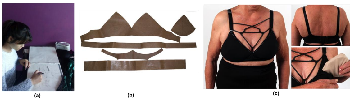
Figura 3: Etapas do desenvolvimento do produto: (a) geração de alternativas; (b) modelagem do produto; (c) teste do protótipo na usuária. Fonte: elaborada pela aluna.
